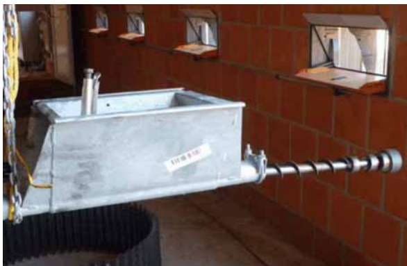
Ilustración 6-4: Fijar la espiral con unas tenazas
