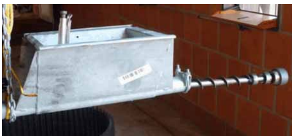
Ilustración 6-6: Espiral en el eje de tensión
