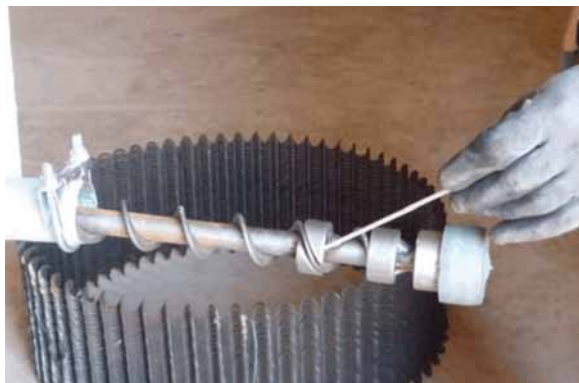
Ilustración 6-5: Soltar la espiral del eje de tensión
