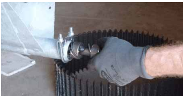
Ilustración 6-8: Sujeción del eje de tensión
