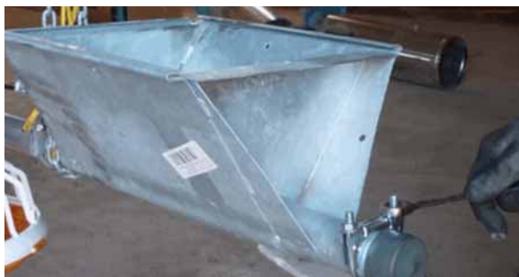
Ilustración 6-9: Fijación del eje de tensión
