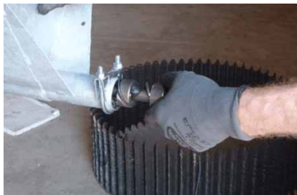
Ilustración 6-3: Extraer el eje de tensión
