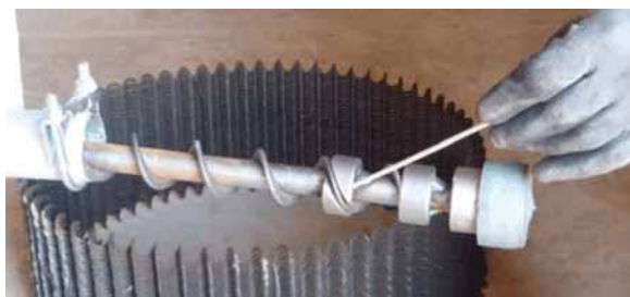
Ilustración 6-7: Fijación de la espiral
